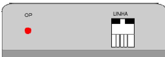
Ligue o equipamento na linha telefônica e a fonte na energia elétrica. O led OP permanecerá piscando e acenderá quando a mesma atender á uma chamada.
